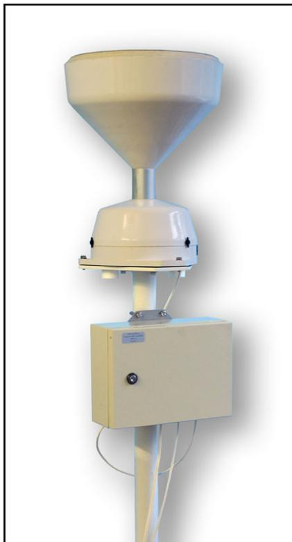
Датчик осадков ИКО-1 предназначен для автоматического измерения твердых, смешанных и жидких атмосферных осадков, обработки и документирования результатов измерений. Датчик может функционировать как обособленное устройство, так в составе АМИС.
